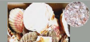
Agroalimentaire: broyage de rebuts sur broyeur BLIK (ici coquilles Saint Jacques)
