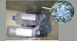
Restauration, hôtellerie, collectivités: Problème de bouteilles plastiques: volume, résidu liquide, etc. Solution: broyage sur broyeur BLIK:
