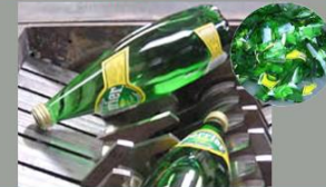
Broyage de bouteilles verre sur broyeur BLIK B400 équipé de couteaux brise-verre
