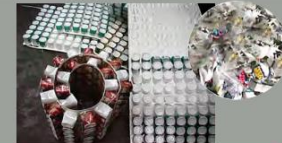
Agroalimentaire: broyage de plastique formé (ici pots de yaourts) sur broyeur BLIK : volume divisé par 10
